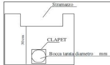
Il volume d'acqua complessivo da stoccare risulta circa di **mc 18.00** Tale stoccaggio potrà essere ottenuto mediante la collocazione di una tubazione perimetrale al lotto del diametro tipo di 400 mm della lunghezza di circa 130 ml dotata di pozzetto con bocca tarata oppure vasche volano o depressioni da collegare al reticolo esistente.
