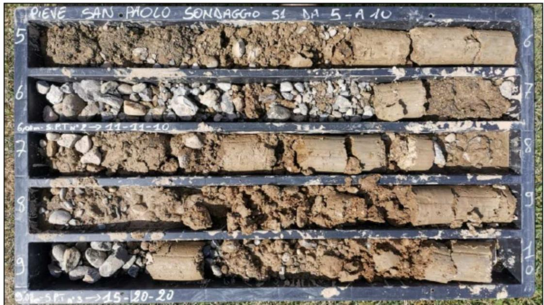
**Figura 3: Sondaggio S1 - Cassetta n.2 da 5.00 a 10.0 metri**
