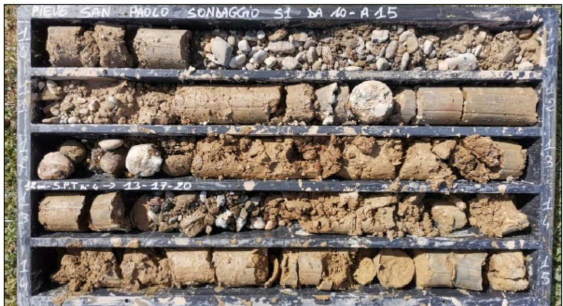
**Figura 4: Sondaggio S1 - Cassetta n.3 da 10.0 a 15.0 metri**
