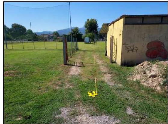
Stesa Sismica a rifrazione di onde SH
