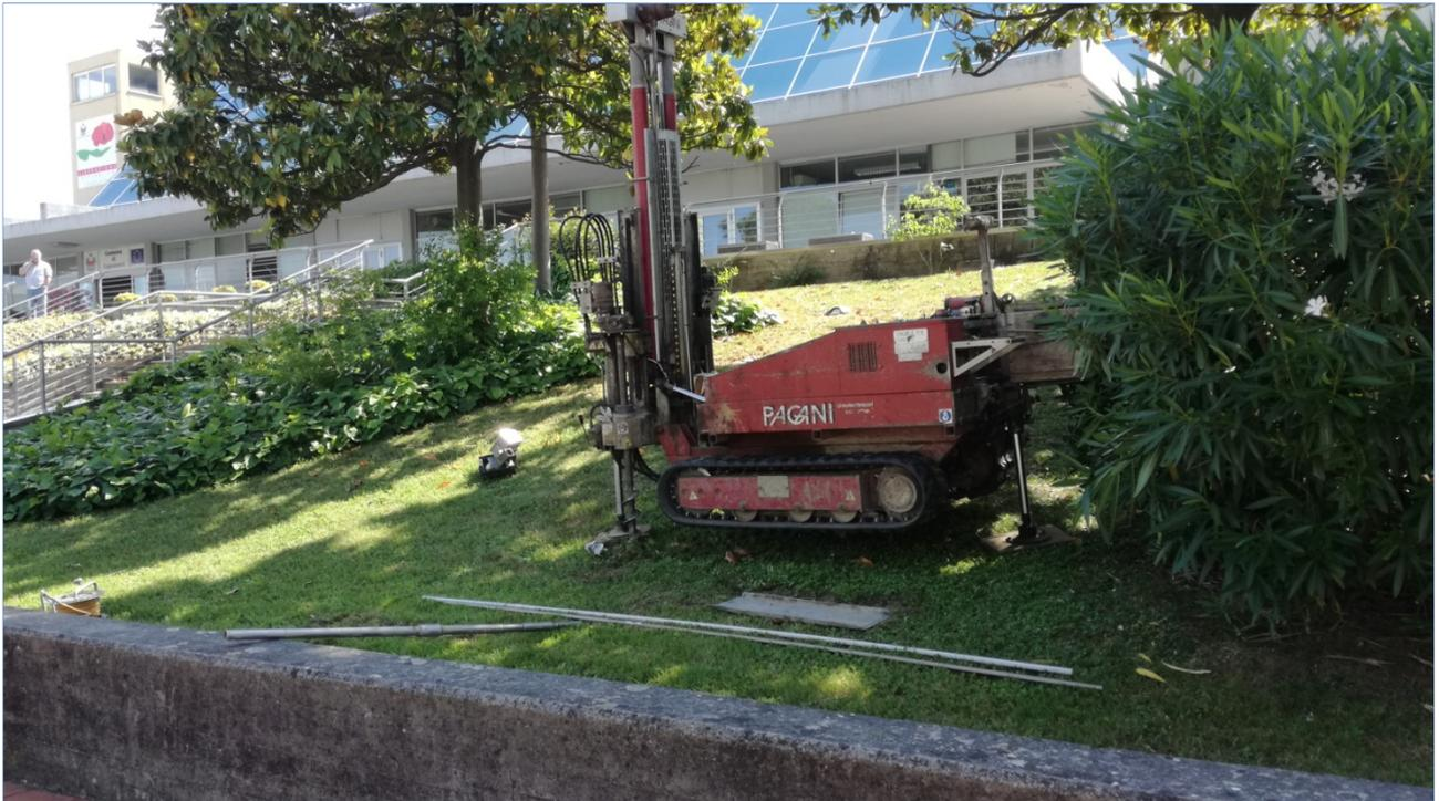
Figura 1: Prova penetrometrica CPT/DIN 1
