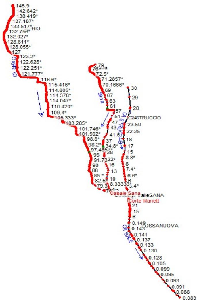
Figura 24 – Schema planimetrico del modello idraulico del sistema della Fossa Nuova
