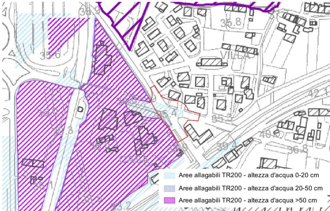
Figura 38 – Stralcio della Tavola A9 (aree allagabili con Tr 200 anni) relativo alla nuova rotatoria in sostituzione dell'incrocio tra viale Europa e via del Fanuccio
